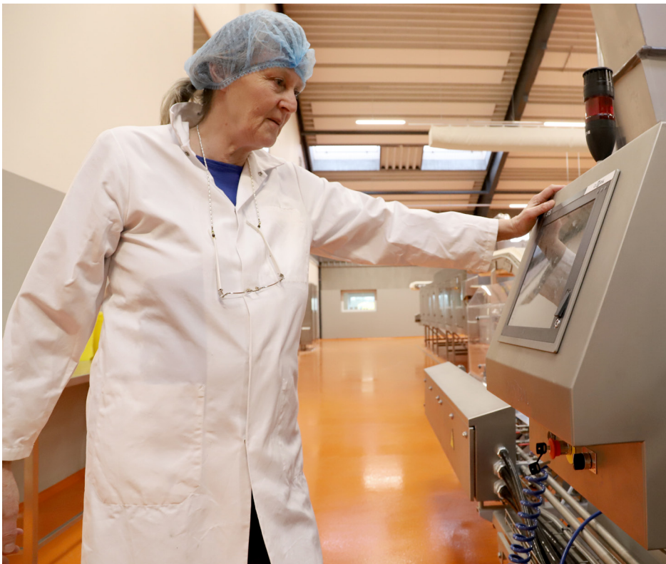
Fie Graugaard studerer en ekstruder i fabrikshallen hos Organic Plant Protein. Maskinen omformer den sammenflettede struktur i planteproteinerne, så det færdige produkt får en struktur, der minder om teksturen i kød fra dyr.
