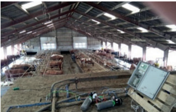
SNIFFER OPSAT OVER EN MALKEROBOT MED TILSLUTNING TIL FODERTRUGET I MALKEREBOTTEN PÅ EN ØKOLOGISK BEDRIFT MED JERSEYKØER.
